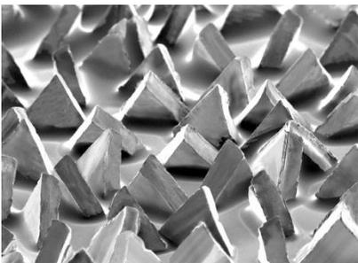
Basierend auf der keramischen Präzisionskorntechnologie generieren die 3M™ Fiberscheiben 782C exzellente Standzeiten und Abtragsergebnisse, besonders bei niedrigem und mittlerem Druck. Diese Fiberscheibe eignet sich hervorragend für den täglichen Gebrauch, ohne Kompromisse in Leistung und Wirtschaftlichkeit einzugehen. Normal wärmeleitende Baustähle, Schmiedestähle und NE-Metalle werden gleichermaßen mit dieser Fiberscheibe in den Körnungen 36+, 60+ und 80+ wirtschaftlich bearbeitet.
